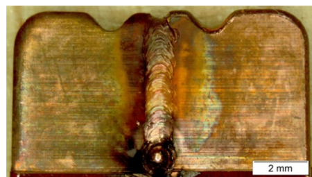
Aufsicht einer laserstrahlgeschweißten Kupferverbindung Top view of a laser beam welded copper joint
