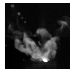
Schweißbrauchausbreitung bei Strahloszillation Weld fume emissions over time from beam oscillation
