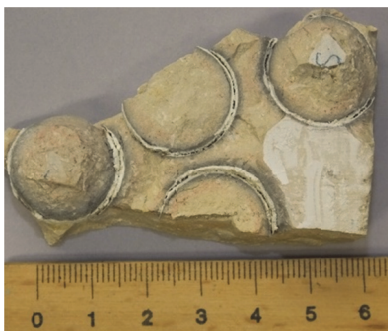
Gesteinsprobe nach Bestrahlung mit Schmelzbildung sowie chemischem Zerfall durch Hitze
