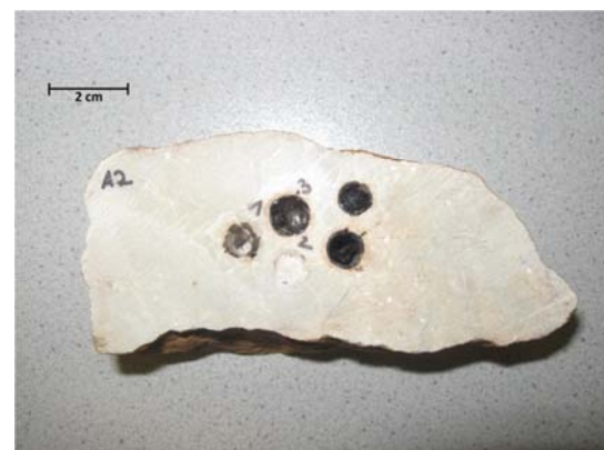
Erste Abtragsversuche am Gestein First laser-ablation trials on rock samples
