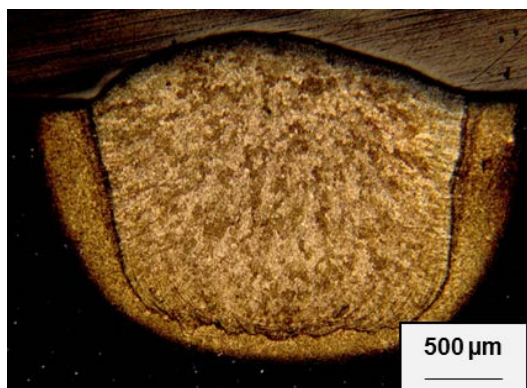
Links: Querschliff eines modifizierten Gefüges; Rechts: Mikrohärtigkeit in Abhängigkeit der Kohlenstoffkonzentration
