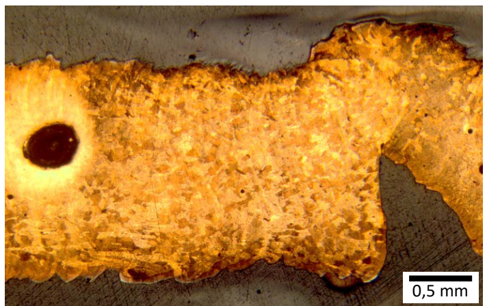
Nahtunregelmäßigkeiten (Pore, Nahtüberhöhung, Wurzelrückfall) im Längsschliff einer Kehlnaht ( P = 6 \text{ kW} ; v = 2 \text{ m/min} ; Cu/Cu). Seam irregularities (pore, weld reinforcement, root regression) in a lengthwise section of a fillet weld ( P = 6 \text{ kW} ; v = 2 \text{ m/min} ; Co/Co).
