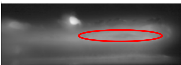
Thermogramm einer Schweißnaht mit einer Anzeige des Risses als dunkler Bereich Thermogram of a weld seam with an indication of the crack as dark area
