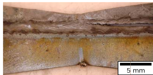
Aufsicht einer laserstrahlgeschweißten Heißrissprobe Top view of a laser beam welded hot crack test specimen
