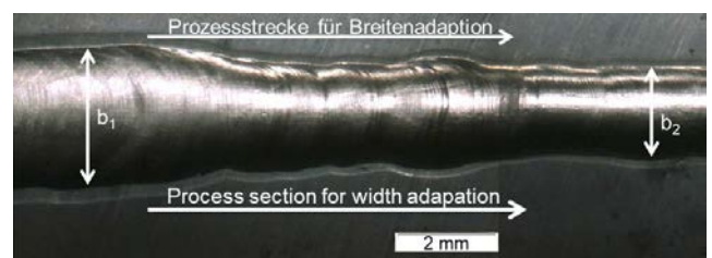
Aufsicht einer Schweißraupe mit variierenden Spurbreiten, erzeugt durch eine InProcess Adaption der Oszillationsamplitude Top view of a weld bead with varying seam widths generated by inprocess adaptation of the oscillation amplitude
